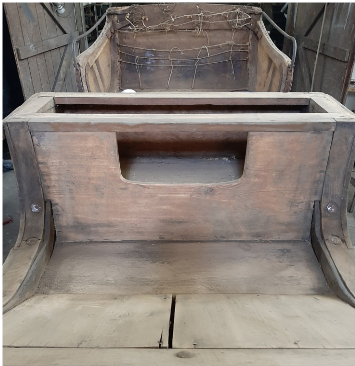
Konserwacja części drewnianych - skrzyni i błotników
