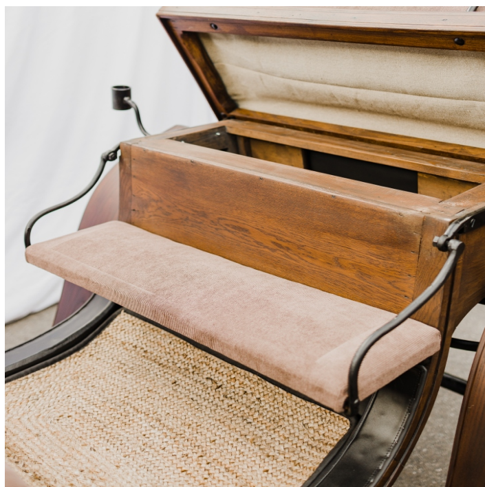
Rekonstrukcja tylnej ławeczki, wymiana tapicerek
