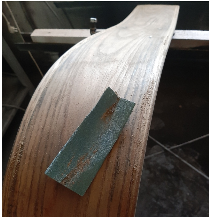
Konserwacja części drewnianych - skrzyni i błotników
