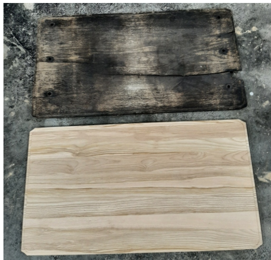
Wymiana uszkodzonej deski frontowej
