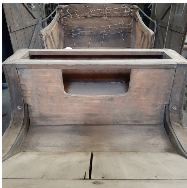
Konserwacja części drewnianych - skrzyni i błotników
