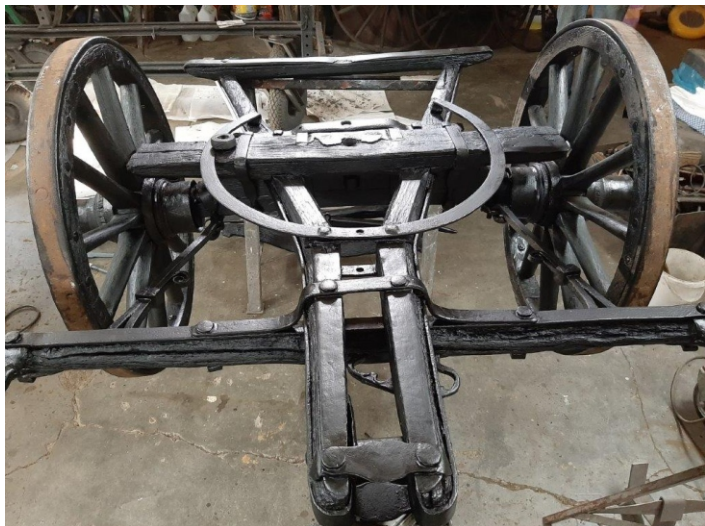
Podwozie i koła w trakcie konserwacji
