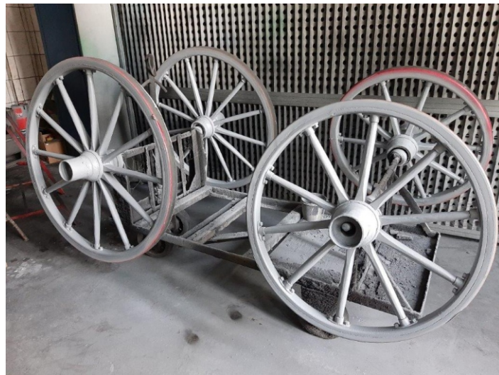
Koła po wyczyszczeniu i ogumowaniu
