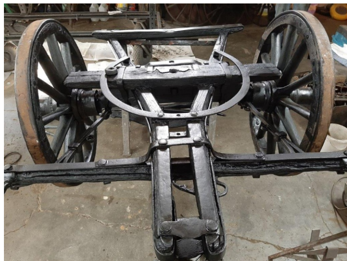
Podwozie i koła w trakcie konserwacji
