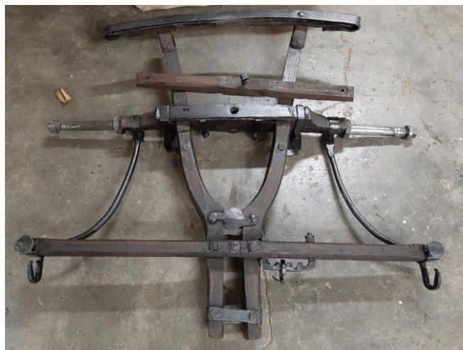
Orczyki, wsporniki skrzyni, elementy podwozia w trakcie konserwacji
