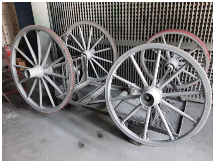
Koła po wyczyszczeniu i ogumowaniu
