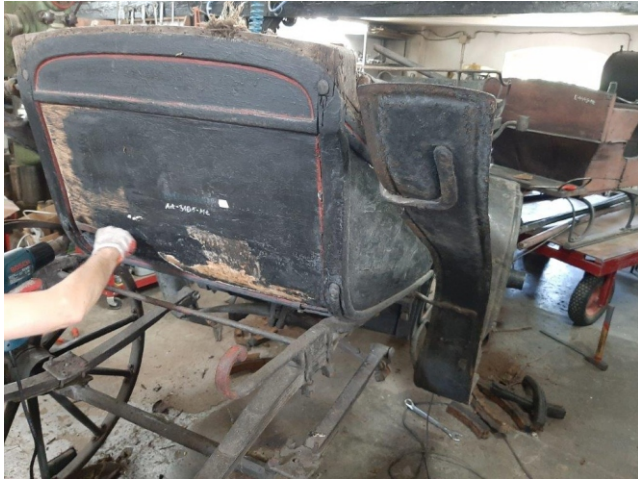
Usuwanie starej powłoki malarskiej
