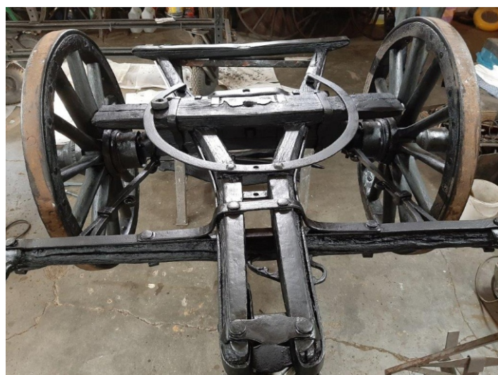
Podwozie i koła w trakcie konserwacji
